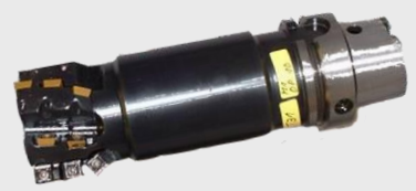
02 瓦尔特铣/镗刀粗加工缸孔包括缸孔下裙边及倒角
