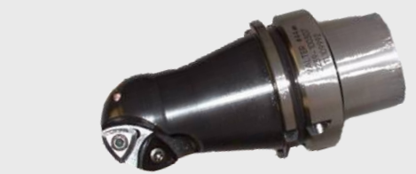
04 瓦尔特球头刀加工曲轴半圆孔
