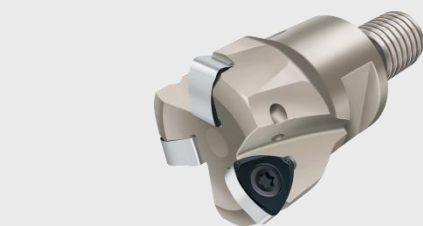
03 瓦尔特Xtra·tec® 高性能铣刀F4030用于粗铣叶片型面
