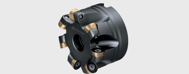
07 瓦爾特的F2334R仿形銑刀用於葉片型面的粗加工
